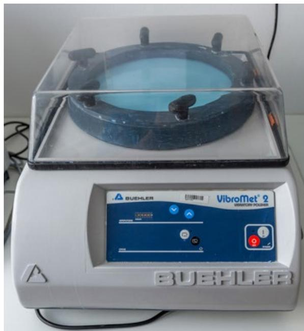
El pulido por vibración es un proceso utilizado para preparar superficies pulidas planas de alta calidad. El proceso es crítico para aplicaciones como la difracción de electrones retrodispersados (EBSD), la microscopía de fuerza atómica (AFM) y la microscopía electrónica de barrido (SEM).
