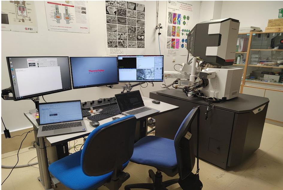
**Apreo ChemiSEM S LoVac** detecta hasta cuatro señales simultáneamente de cualquier combinación de los detectores o segmentos de detector disponibles:
