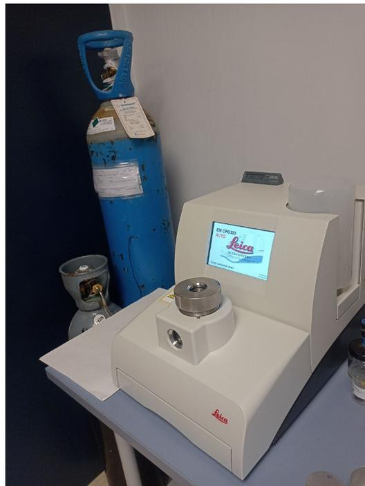
El secador de punto crítico Leica EM CPD300 permite realizar el secado de muestras biológicas (polen, tejido, plantas, insectos, etc.) y de muestras industriales (por ejemplo, de sistemas microelectromecánicos) para análisis por SEM de manera totalmente automática y controlada lo que permite obtener los resultados perfectos y reproducibles y garantiza la misma calidad de muestra en cada análisis
