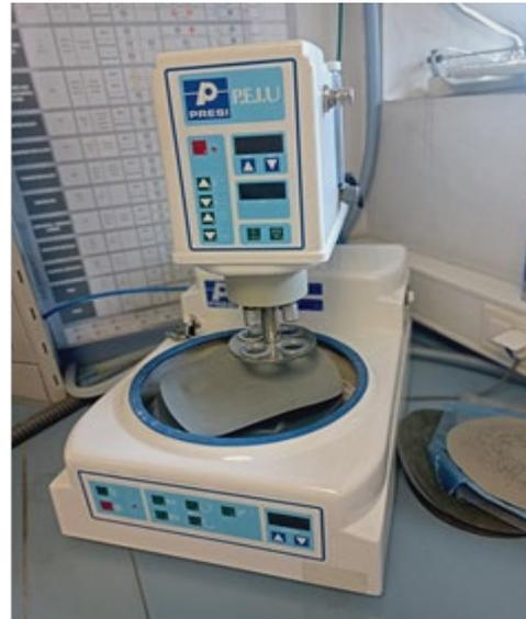
El pulido metalográfico es un paso en la preparación mecánica de la muestra para el posterior examen microscópico.
