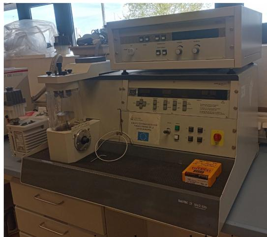
El recubrimiento de muestras es necesario en el campo de la microscopía electrónica para permitir o mejorar la obtención de imágenes de las muestras. La creación de una capa conductora de metal sobre la muestra inhibe la carga, reduce el daño térmico y mejora la señal de electrones secundarios necesaria para el examen topográfico en el SEM. Se necesitan finas capas de car-
