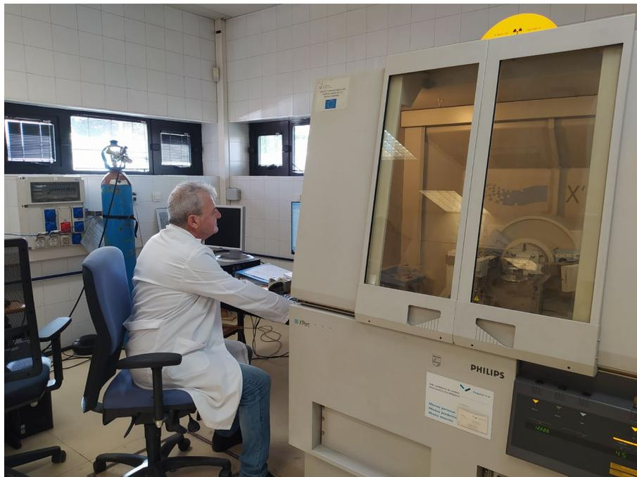
**Espectrómetro de fluorescencia de rayos X de Panalytical, modelo MagiX.**
