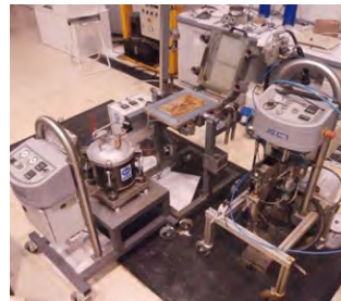
Equipo de infusión de resina en molde (Resin Transfer Moulding, RTM)
