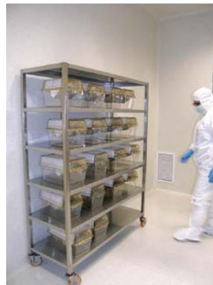
de un sistema ventilación del aire de entre 15 y 25 renovaciones por hora dependiendo de la densidad de ocupación de cada habitación, y un sistema de filtros que garantice la calidad del aire.
