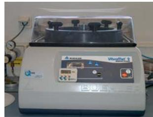
El movimiento horizontal a 7200 ciclos por minuto produce una acción de pulido muy eficaz con resultados de calidad superior y excepcional para superficies perfectamente planas. La acción vibratoria controlada produce menos deformación, superficies planas y reduce los bordes redondeados.
