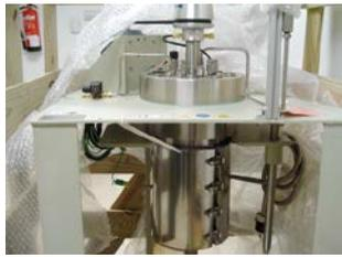
**Reactor de laboratorio agitado para alta presión y temperatura en acero inoxidable con capacidad de 7,5 y 18,8 litros**
