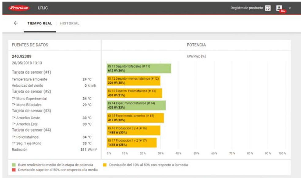
Además, la instalación cuenta con sondas de temperatura ambiente, una célula para medir la radiación que ha caído en la zona, y un anemómetro. Todos los datos de estos sensores son recogido por un sistema de monitorización, instalado en el ordenador del centro de control
