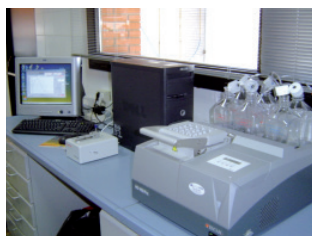
Estación de hibridación de microarrays modelo HS400 Pro (Tecan).
