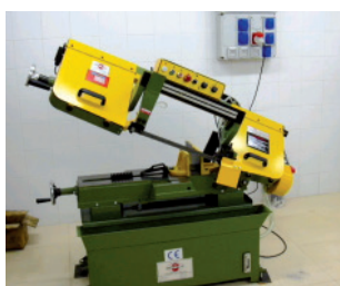
Tronzadora de cinta marca BEMATO modelo UE-916 A
