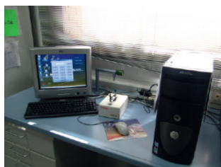
Espectrofotómetro modelo Nanodrop 1000 (Thermo Scientific)
