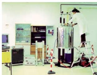
Unidad formada por dos espectrómetros multinucleares superconductores de Resonancia Magnética Nuclear, con intensidad de campo 9.4 Teslas (1H, 400 MHz), ambos cuentan con unidad de temperatura variable (-40 a 130°C) y un tercer equipo con intensidad de campo de 500 MHz.
