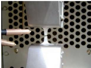
Las máquinas universales de ensayos MTS se pueden complementar con una cámara ambiental para poder controlar la temperatura de ensayo entre los 128,9 °C y los 351,6 °C.
