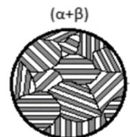
b) La reacción eutéctica se produce a una temperatura de  $900 \text{ }^\circ\text{C}$ , que se corresponde con la aleación con 60% de B y 40% de A. La microestructura eutéctica está formada por láminas alternadas de las dos fases presentes.
