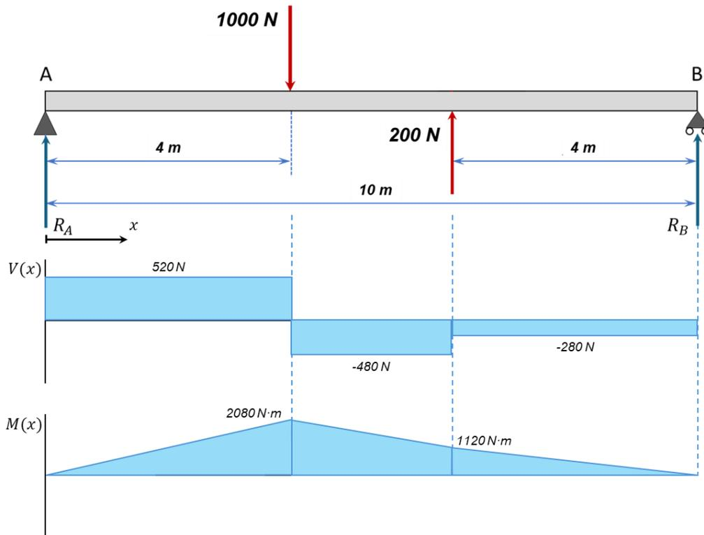
**Nota:** calculado planteando el equilibrio de un tramo finito de la viga, pero también sería válido calcularlo teniendo en cuenta que  $\frac{dM(x)}{dx} = V(x)$  en cada tramo, con derivadas o integrales.
