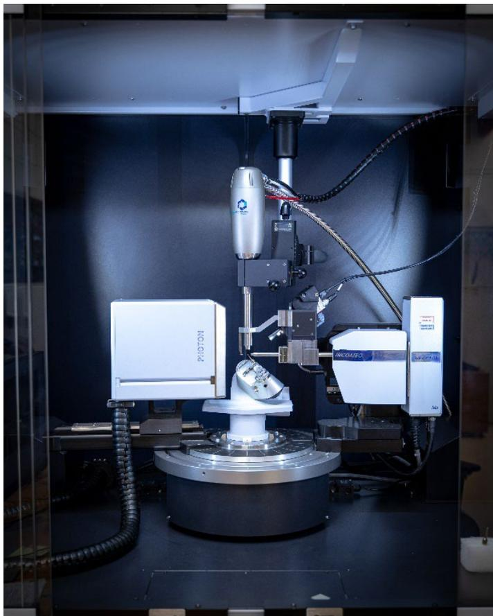
**Difractómetro de rayos X de polvo Empyrean** de Panalytical, con geometría  $\theta/\theta$ , con los siguientes accesorios:
