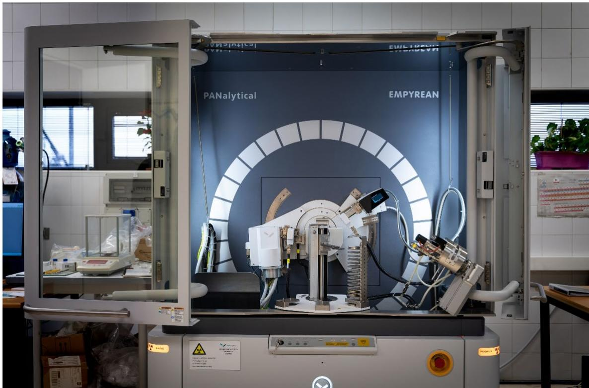
**Difractómetro X'Pert PRO de Panalytical**, con geometría  $\theta/2\theta$ , con los siguientes accesorios:
