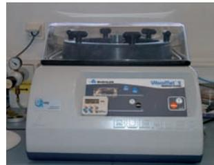
También se obtiene una superficie libre de estrés sin llegar al uso de electrolitos y problemas asociados con electro-pulido o bombardeo de iones. El plato de pulido (305 mm) plato pulido y cubierta moldeada transparente son estándar en esta unidad, así como, una gran variedad de soportes para muestras y pesos.
