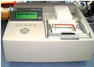
Estación de preparación de ácidos nucleicos ABI Prism 6100 Nucleic Acid PrepStation.
