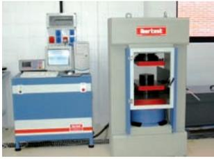
**Máquina hidráulica Ibertest MEHP de 3000 kN:**
