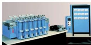
**FRESADORA MINICUTVIS (CEAST)**, para obtención de probetas de polímeros para realizar ensayos mecánicos según las normas ASTM D1525, ASTM D638, ASTM D790, ASTM D256, ASTM D648, ISO179, ISO180 entre otras.
