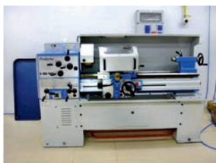
Torno marca PINACHO modelo SP-180 con escote
