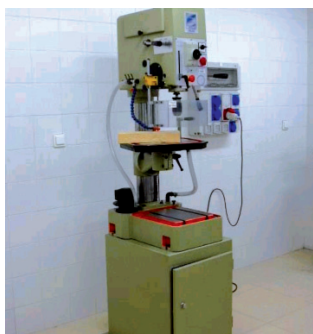
Taladro de sobremesa marca ERL0 modelo SR-18
