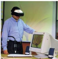
2 Cascos de realidad virtual V6 de Virtual Research System con display de 1,3", resolución por ojo de 640x480 y campo de visión de 260° que permite la visualización de imágenes en forma estereoscópica.
