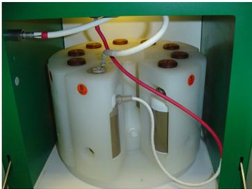
Horno microondas ETHOS PLUS de la casa comercial Milestone, equipado con un rotor con 10 vasos de síntesis para alta presión y temperatura. Potencia máxima del equipo 1600 W. Dispone de software para su control.
