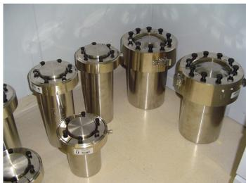
Reactores estáticos de síntesis con capacidades de 1, 2 y 3,75 litros de la casa comercial Parr Instrument Company. Los límites máximos de presión y temperatura de estos reactores son 130 bar y 350°C, respectivamente.
