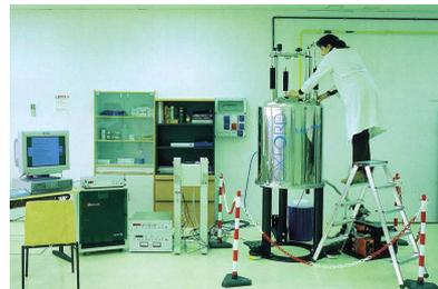
Varian – 400 MHz Mercury Plus: Equipo específico para muestras líquidas.
