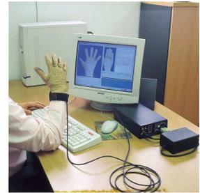
Dispositivos hápticos que permiten al ordenador proporcionar una retroalimentación táctil, es decir, dar la impresión de estar tocando un objeto que no existe en la realidad, en concreto un equipo háptico genérico PHANTOM Premium 1.5 de Sensable con resolución de 0,03 mm y máximo esfuerzo de 8,5 Nw, y dos equipos hápticos orientados a simulaciones virtuales de operaciones de laparoscopia Laparoscopic Impulse Engine de Immersion con una resolución de 0,025 mm.
