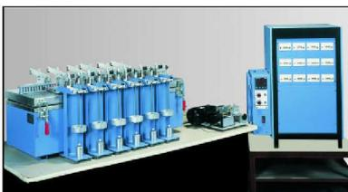
**PRENSA PLA-30** de 19,2 KW de potencia con grupo de refrigeración incorporado, para moldear los polímeros en forma de probetas para diferente tipo de ensayos de caracterización.
