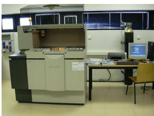
Espectrómetro de Fluorescencia de Rayos X Philips, modelo MagiX. Espectrómetro por dispersión de longitudes de onda, con generador de Rayos X de 1KW y ánodo de rodio. Dotado de 3 colimadores primarios intercambiables, cambiador de cristales bi-direccional con hasta 8 posiciones.
