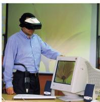
2 Cascos de realidad virtual V6 de Virtual Research System con display de 1,3", resolución por ojo de 640x480 y campo de visión de 260º que permite la visualización de imágenes en forma estereoscópica.
