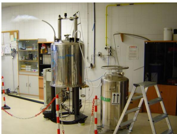
**Espectrómetro Bruker AVANCE III HD-WB – 400 MHz**, Equipo específico para muestras sólidas con sistema neumático de control de rotación de la muestra hasta 25 kHz. Cuenta con sondas 2,5 mm (162-40.5 MHz)/1H-19F (400-376.5 MHz), 4 mm 31P-13C (162-100 MHz) /19F (376.5 MHz) y 7,5 mm de Varian adaptadas a Bruker (162-40.5MHz) con caja de baja frecuencia para analizar núcleos low gamma (40-10 MHz). Todas con temperatura variable (-80°C-130°C).
